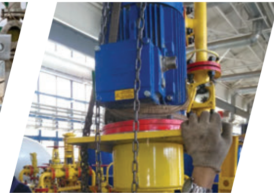
科纳尔集团股份有限公司 交付用于压缩机装置的带防爆电机的 容积式螺杆泵
