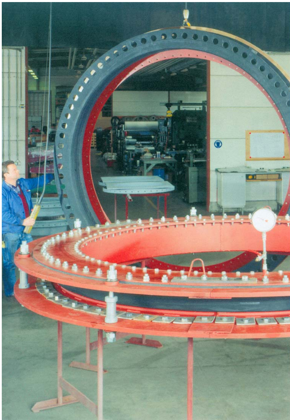
Рис. 10 Испытание компенсаторов на прочность
