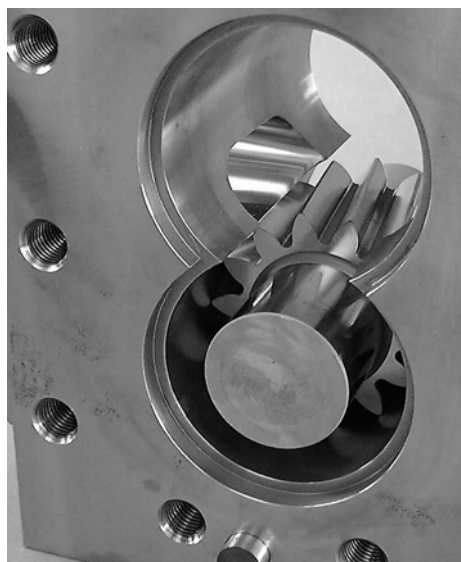
Рисунок 8.15 Вытяните короткий вал и зафиксируйте его подъемными ремнями
