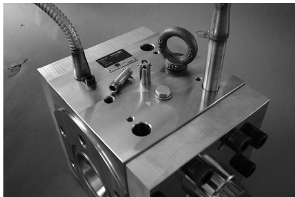
Рисунок 8.30 Монтаж нагревательных патронов и переходника для термозонда
