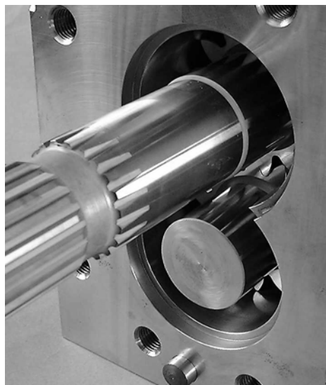
Рисунок 8.13 Валы, подготовленные к демонтажу
